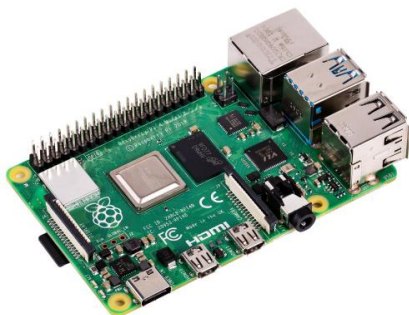
Figure 10 : Raspberry Pi 4B utilisé comme passerelle MQTT ↔ Firebase
