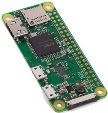
Figure 11 : Raspberry Pi Zero W intégré dans chaque casier physique
